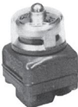
Датчик положения серии 803 информирует, что подающий баллон пуст и что регулятор берет газ из резервного баллона. Прозрачный колпачок позволяет видеть положение индикатора со всех сторон.
